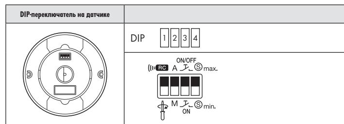
Индивидуальные настройки можно задать с помощью пульта дистанционного управления или вручную с помощью органов управления путем переключения многопозиционного переключателя DIP 1 (см. рисунок).
